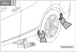
Установите домкратную рукоятку, как показано на рисунке, затем вставьте в рукоятку гаечный ключ для затяжки гаек ступицы. Поверните гаечный ключ по часовой стрелке, и поднимите автомобиль домкратом, чтобы колеса немного оторвались от земли.
