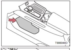
Ящик для хранения на втором этаже вспомогательной приборной панели.
