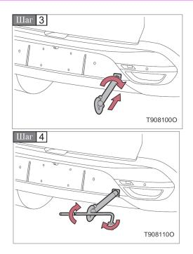
Вставьте сцепное устройство в отверстие и слегка затяните его рукой.
