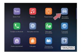
Нажмите на [Настройки автомобиля] на рабочем столе приложения, чтобы войти в интерфейс настроек.
