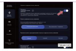
Переключатель системы предупреждения о выезде за пределы полосы движения расположен в модуле "Помощь водителю" в разделе "Настройки автомобиля" на центральном экране управления.
