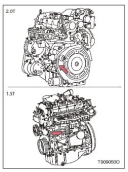
Модель двигателя и заводской номер выбиты на блоке двигателя, как показано на рисунке.
