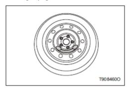
Оснащен неполноразмерной запасной шиной, отличающейся по спецификации от спецификации эксплуатируемого автомобиля и предназначенной только для временного использования. Необходимо соблюдать особую осторожность при движении и как можно скорее заменить штатные колеса.
