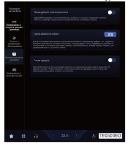
Ha странице вспомогательных функций менеджера автомобиля можно включить/выключить режим ремонта стеклоочистителей, сбросить давление в шинах включить/выключить режим прицепа.
