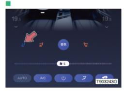
Нажмите кнопку вентиляции сидений в интерфейсе кондиционера экрана центрального управления, чтобы включать / выключать /регулировать уровень вентиляции сидений.
