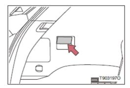
Лампа освещения багажника загорается при открытии багажника и гаснет при закрытии багажника.
