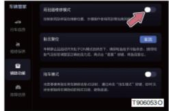
Перед тем как коснитесь выключателя режима ремонта стеклоочистителя в модуле "Вспомогательные функции" в разделе "Менеджер автомобиля" на экране управления, центрального И тогда стеклоочиститель остановит в положении облегчает ремонта, что снятие шеток стеклоочистителя.
