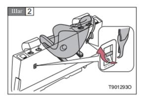
Надежно закрепите прихват на опоре крепежных якорей и затяните верхний натяжной ремень.
