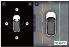
При положении R и скорости автомобиля менее 10 км/ч (километров в час), если к автомобилю сзади слева или справа приближается автомобиль (в зоне, показанной на рисунке) и время столкновения составляет менее 2,5 секунд, загорается сигнализатор наружного зеркала заднего вида на соответствующей стороне.
