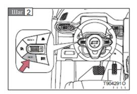
Доведите автомобиль до желаемой скорости, затем, нажмите выключатель SET/- при одновременном отпускании педали акселератора, и автомобиль будет постоянно текущую поддерживать заданную равномерную скорость круиза. (Если текущая скорость ниже 30 км/ч, автомобиль устанавливает скорость круиза на 30 км/ч).
