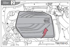
Снимите кожух украшения двигателя.
