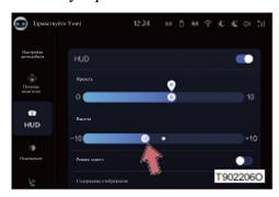
В модуле "HUD" раздела "Настройки автомобиля" на экране центрального управления можно коснуться / передвинуть для регулирования выключателя регулировки высоты, и тогда отображение будет двигаться вверх; можно коснуться / передвинуть вправо для регулирования выключателя регулировки высоты, и тогда отображение будет двигаться вниз.
