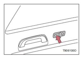
Нажмите на переключатель, чтобы включить или выключить задние лампы для чтения.
