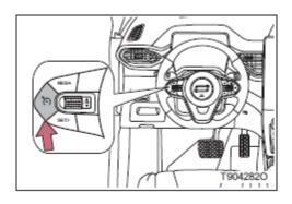
Нажмите на выключатель круиз-контроля, чтобы включить/выключить функцию круиз-контроля.
