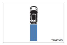
При срабатывании функции предупреждения о заднем столкновении все указатели поворота мигают не более 3 секунд, и если в течение 3 секунд процесса предупреждения условия предупреждения отсутствуют, то предупреждение мгновенно прекращается, а на соответствующем приборе появляется индикация, как показано на рисунке.
