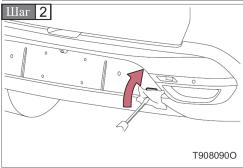
Снимите крышку отверстия сцепного устройства прицепа с помощью плоской отвертки или аналогичного инструмента.
