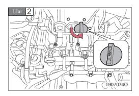
Поверните крышку маслозаливной горловины против часовой стрелки, чтобы снять ее.
