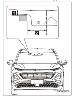
Электронный идентификатор автомобиля наносится на внутреннюю сторону ветрового стекла.
