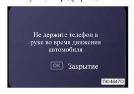
Система отслеживает текущее состояние водителя в режиме реального времени, и если что у водителя плохое обнаруживается, поведение вождения (курение, телефонные звонки и т.д.), то система определяет, что в состоянии плохого водитель находится вождения, выдает соответствующую информацию в виде всплывающего окна на чтобы напомнить необходимости безопасного вождения.
