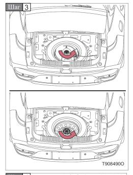
Снимите крепление запасной шины.
