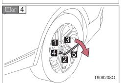
Плотно затяните каждую гайку колеса два или три раза в указанном порядке. Крутящий момент крепления: 108-147 Н·м (Ньютон·метр)
