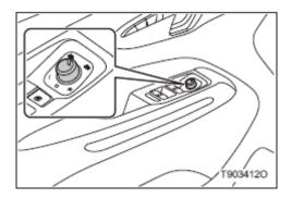
Переведите выключатель наружных зеркал заднего вида в положение, показанное на рисунке, для обогрева наружных зеркал заднего вида и выведите его из этого положения для прекращения подогрева.
