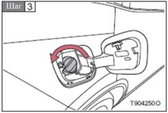
Нажмите на задний край крышки заливной горловины, чтобы открыть ее.
