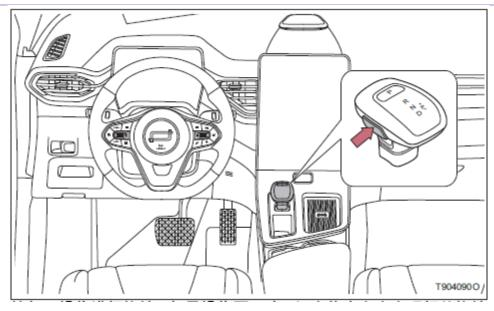
Переключите передачи в соответствии с следующими шагами. Если операция выполнена неправильно, на комбинированном приборе появятся соответствующие оповещения по переключению передачи, и переключение можно выполнить в соответствии с подсказками по переключению передачи на комбинированном приборе.
