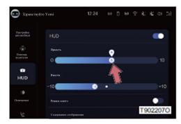
Яркость отображения головного дисплея регулируется прикосновением / перемещением модуля "HUD" в разделе "Настройки автомобиля" на экране центрального управления.
