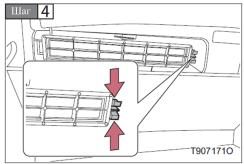
Отсоедините фиксатор крышки фильтра, чтобы снять крышку фильтра.
