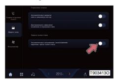
По пути "Настройки автомобиля" на экране центрального управления, модуля "Двери и окна" может включать / выключать эту функцию.
