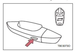
При выключенном выключателе запуска двигателя дверей И закрытии всех блокировки багажника нажмите кнопку дверей на двери водителя, чтобы заблокировать все двери; и нажмите еще раз, чтобы разблокировать все двери.
