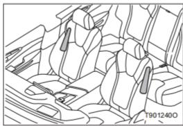
Автомобили, оборудованные подушками безопасности сидений: на поверхности сидений имеются царапины, трещины или другие повреждения.
