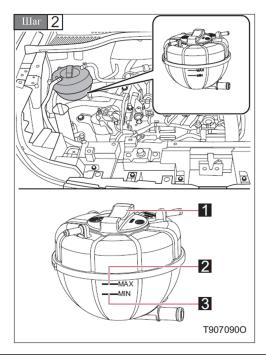
Проверить уровень охлаждающей жидкости в бачке.
