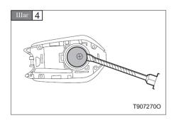
Извлеките батарею с помощью отвертки, обмотанного защитной лентой, или аналогичного инструмента, как показано на рисунке.
