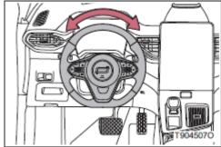
Способ IV: Угол поворота рулевого колеса превышает 13° по сравнению с последней остановкой, и двигатель запустится автоматически.
