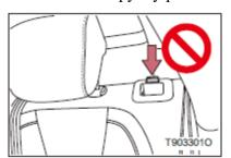
Проверьте убедитесь, И ЧТО предупреждающая кнопка находится в Если нажатом положении. предупреждающая кнопка все еще находится во всплывающем состоянии, это означает, что спинка не зафиксирована.
