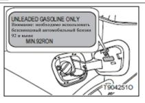
На крышке заливной горловины имеются предупреждающие наклейки, поэтому обязательно используйте указанный тип топлива.
