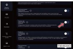
Переключатель функции помощи при смене полосы движения в модуле "Помощь водителю" в разделе "Настройки автомобиля" большого экрана центрального управления, и все функции включены по умолчанию, и с помощью этого переключателя можно включить/выключить функцию помощи при смене полосы движения.
