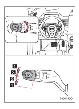
АUTO Фара ближнего света, передние/задние габаритные огни, фонари освещения номерного знака, атмосферная подсветка\* и лампы подсветки выключателя включаются или выключаются автоматически (когда выключатель запуска двигателя находится в режиме ON).
