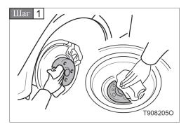
Удалите грязь и посторонние предметы с контактных поверхностей колес.
