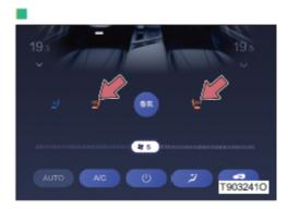
Нажмите кнопку подогрева сидений в интерфейсе кондиционера экрана центрального управления, чтобы включать / выключать /регулировать уровень подогрева силений.
