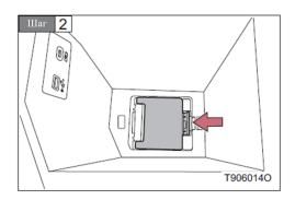
Снимите прокладку вещевого ящика и нажмите на фиксатор вещевого ящика, чтобы извлечь его.
