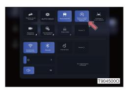
Кнопка выключения запуска и остановки на холостом ходу является плавным выключателем на экране центрального управления.
