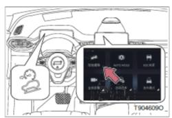
Переключатель контроля спуска со склона находится в модуле "Помощь водителю" в разделе "Настройки автомобиля" на центральном экране управления или в программном переключателе центрального экрана управления.
