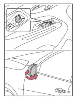
Переведите выключатель наружных зеркал заднего вида в положение, показанное на рисунке, чтобы сложить наружные зеркала заднего вида, и сдвиньте его из этого положения, чтобы вернуть их в исходное положение.
