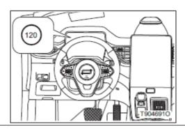
Когда система распознает знак ограничения скорости перед автомобилем, на индикаторе интеллектуального напоминания об ограничении скорости на комбинированном приборе отображается номер на знаке.
