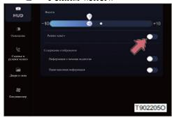
Коснитесь выключателя, чтобы включить / выключить режим «снег».
