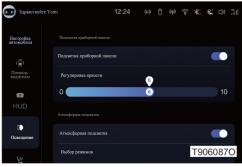
Модуль "свет" в разделе "настройки автомобиля" на центральном экране позволяет включать или выключать подсветку приборной панели, а также регулировать ее яркость.
