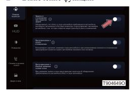
Переключатель функции предотвращение столкновения при открывании дверей в модуле "Помощь водителю" в разделе "Настройки автомобиля" большого экрана центрального управления, и все функции включены по умолчанию, и с помощью этого переключателя можно включить/выключить.
