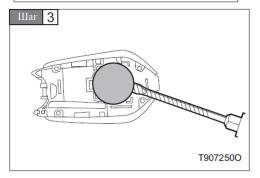
Снимите защитную крышку аккумулятора.
