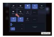
Выключатель панорамной камеры с отрицательным экраном может включать/выключать функцию панорамной камеры и функцию парковочного радара. Выключатель расположен в выпадающем меню экрана центрального управления и является плавным выключателем.
