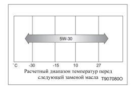
Никогда не используйте моторное масло высокой вязкости при экстремально низких температурах, иначе двигатель может быть трудно запустить. Рекомендуется использовать масло, соответствующее требованиям автомобиля.
