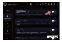
Выключатель предупреждения о пересечении передним ходом в модуле "Помощь водителю" в разделе "Настройки автомобиля" большого экрана центрального управления, и все функции включены по умолчанию.
