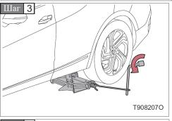
Установите запасное колесо и слегка затяните вручную гайки каждого колеса примерно на одинаковую величину.
