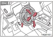
Удерживая рулевое колесо, надавите вниз на рычаг регулировки.
