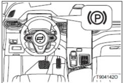
При запуске двигателе, пристегнутом ремне безопасности водителя и закрытой двери водителя выберите программный переключатель на центральном экране управления, переключатель подсвечивается, и система переходит в режим ожидания.
