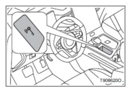
Поместите смарт-ключ в метку для ключей в ящик для хранения на вспомогательной приборной панели и нажмите на кнопку запуска двигателя; если в автомобиле обнаружен штатный ключ, двигатель запустится.
