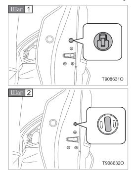
Откройте дверь И снимите резиновую крышку с торцевой поверхности двери.
