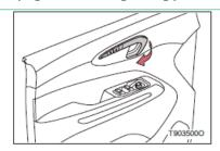
После блокировки дверей потяните за внутреннюю дверную ручку левой передней двери, и дверь откроется. Для других дверей дважды потяните за внутреннюю дверную ручку, и соответствующая дверь откроется.
