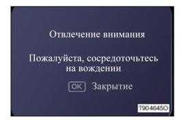
Система отслеживает текущее состояние водителя в режиме реального времени, если внимание водителя отвлечено (долго смотрит влево и вправо, долго линия зрения находится за пределами дороги), система определит, что водитель находится в состоянии отвлечения внимания, выдает соответствующую информацию в виде всплывающего окна на чтобы приборе, напомнить водителю необходимости безопасного вождения.
