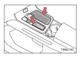
Ящик для хранения на передней панели под приборной панелью.
