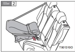
Пропустите ремень безопасности через детское удерживающее устройство и вставьте фиксатор в пряжку. Обеспечите отсутствие скручивания ремня безопасности.
