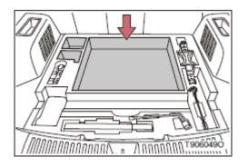
Поднимите ковер багажного отделения, чтобы получить доступ к резервному вещевому ящику для инструментов.
