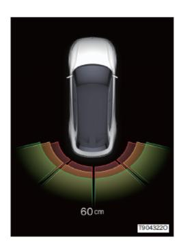
При обнаружении препятствия на экране центрального управления загорается соответствующий цветовой блок, а динамик подает звуковой сигнал с определенной частотой, чтобы предупреждать водителя. Отображение приведено только для справки, за основу принимайтесь отображение фактического автомобиля.
