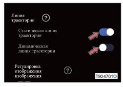
Можно проводить настройку включения и выключения динамической линии траектории и статической линии траектории.
