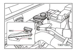
Следите за уровнем тормозной жидкости в бачке.
