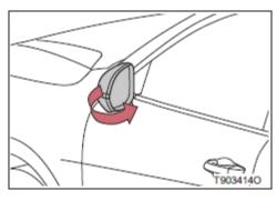
Сдвиньте наружное зеркало заднего вида к задней части автомобиля, чтобы складывать его.
