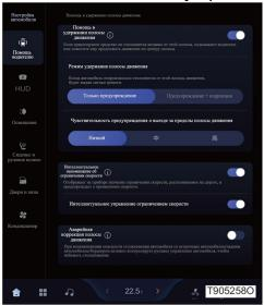
Переключатель помощи в удержании полосы движения: включение или выключение функции помощи в удержании полосы движения.
