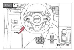
Дважды потяните ручку открытия капота наружу, и капот слегка приподнимется.
