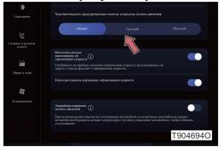
Чувствительность системы предупреждения о выезде за пределы полосы движения можно настроить через модуль "Помощь водителю" в разделе "Настройки автомобиля" на центральном экране управления.
