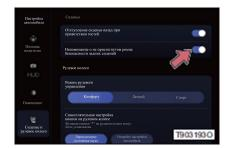
По пути "Настройки автомобиля" на экране центрального управления, модуля "Сиденье и рулевое колесо" может включать / выключать функцию отступления сиденья назад при приветствии гостей.
