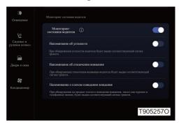
Переключатель мониторинга состояния водителя: включение или выключение функции мониторинга состояния водителя.
