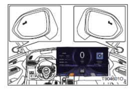
В зоне обнаружения при появлении автомобиля всегда горит сигнальная лампа наружного зеркала заднего вида, при включении переключателя рулевого управления или при превышении угла поворота рулевого колеса определенного значения мигает сигнализатор наружного зеркала заднего вида, одновременно звуковая система запрашивает соответствующий боковой динамик, и на приборе появляется соответствующий дисплей сигнализации.
