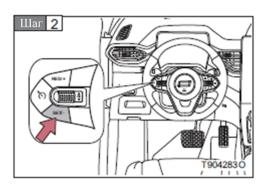
Доведите автомобиль до желаемой скорости (выше 30 км/ч (километров в час)), затем нажмите выключатель, отпустив педаль акселератора, и автомобиль будет постоянно поддерживать текущую установленную равномерную скорость круиза.
