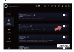
Плавный выключатель функции находится в модуле "Помощь водителю" "Настройки автомобиля" на экране центрального управления, через который можно включать/выключать функцию интеллектуальной смены полосы движения на скоростной дороге.
