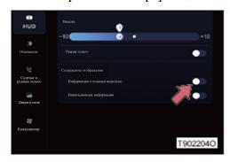
Коснитесь выключателя, чтобы включить / выключить отображение информации о помощи водителю.
