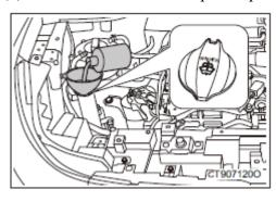
Откройте крышку бака для чистящей жидкости и добавьте чистящую жидкость.
