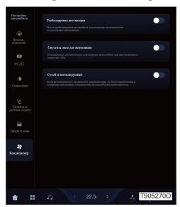
Можно настроить включение/выключение вентиляции без блокировки, включение/выключение вентиляции с опусканием окон и включение/выключение сушки вентиляции.
