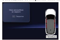
Если выключатель запуска выключен, а окна закрыты не полностью, на комбинированном приборе появятся текст и изображения, чтобы напоминать пользователям об открытии окон.
