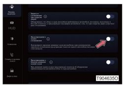
Переключатель функции предупреждения о заднем столкновении в модуле "Помощь водителю" в разделе "Настройки автомобиля" большого экрана центрального управления, и все функции включены по умолчанию, и с помощью этого переключателя можно включить/выключить.
