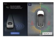
Когда двигатель запускается и скорость автомобиля составляет 25 км/ч (километров в час) или ниже, нажмите выключатель автоматической парковки, на экране центрального управления появится интерфейс выбора режима парковки, после того, как выберите горизонтальную или вертикальную парковку в места, система входит в режим "Поиска парковочного места".
