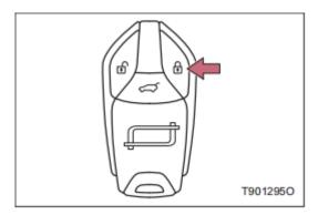
Закройте все двери, багажник и капот и заблокируйте все двери любым из следующих способов. Указатель поворота мигает один раз при успешной блокировки и активируется противоугонная система кузова автомобиля.
