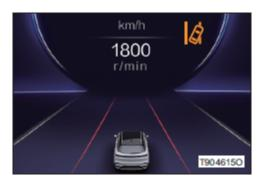
Когда система находится в режиме ожидания активирована, если линия полосы движения не обнаружена, индикатор состояния системы предупреждения о выезде пределы полосы движения комбинированном приборе горит серым цветом, а левая и правая полосы движения на отображаются вспомогательном дисплее серым цветом.
