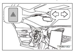
При нажатии выключателя аварийной сигнализации все указатели поворота будут мигать. Повторное нажатие на этот переключатель отключает эти указатели.
