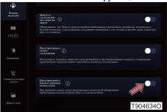
Переключатель функции предупреждения о боковом движении задним ходом в модуле "Помощь водителю" в разделе "Настройки автомобиля" большого экрана центрального управления, и все функции включены по умолчанию, и с помощью этого переключателя можно включить/выключить
