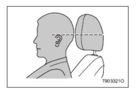
При регулировании подголовника необходимо обеспечить, чтобы его центр находился параллельно верхней части ушей.
