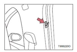
Крючки для одежды расположены на верхней панели отделки стойки В.
