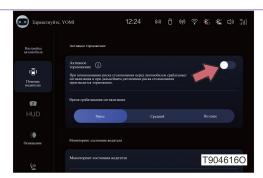
Когда переключатель запуска двигателя находится в режиме ON, активная тормозная система может быть включена/выключена с помощью большого экрана центрального управления.
