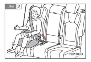
Усадите ребенка в кресло для подростков (вспомогательное кресло). Закрепите кресло для подростков (вспомогательное кресло) ремнем безопасности и вставьте фиксатор в пряжку в соответствии с инструкциями, предоставляемыми производителем. Обеспечите отсутствие скручивания ремня безопасности.
