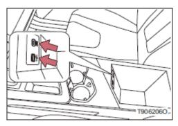
осле включения акустической системы интерфейс USB обеспечивает функцию зарядки USB-устройств.
