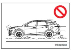
Движение по залитой водой дороге легко может привести к заглоханию двигателя, короткому замыканию электрических деталей и попаданию воды. Не пытайтесь запустить двигатель после его заглохания, иначе это может привести к серьезным повреждениям двигателя.
