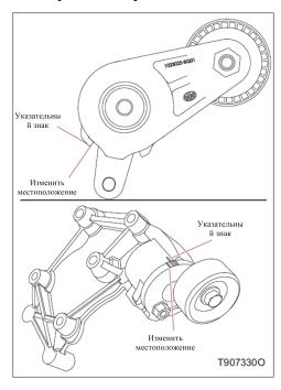
Проверьте прогиб и натяжение приводного ремня, визуально убедившись, что метка указателя на автоматическом натяжном ролике приводного ремня совпадает с положением замены. Если уже выровнен, приводной ремень необходимо немедленно заменить.
