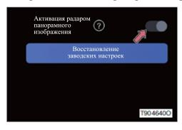
Можно проводить настройку включения и выключения активации радаром панорамного изображения, когда функция включается, система контроля панорамного изображения активируется после того, как радар подаст соответствующий сигнал.
