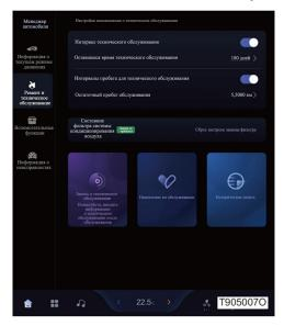
На странице технического обслуживания автомобиля отображаются менеджера напоминания частей: Настройка 0 обслуживании, техническом запись 0 техническом обслуживании, напоминание о фильтроэлемента кондиционера, замене назначение на обслуживание и историческая запись.
