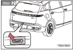
Поднимите центральную часть крышки багажника, чтобы полностью открыть ее.
