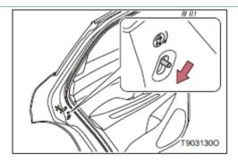
Переключите выключатель вниз, чтобы установить детский предохранительный замок задней двери, после установки замка безопасности дверь нельзя открыть изнутри автомобиля.
