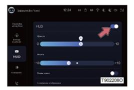
Включение и выключение головного дисплея осуществляются в модуле "HUD" в разделе "Настройки автомобиля" на экране центрального управления.
