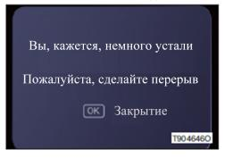
Система предварительно устанавливает три уровня напоминаний об усталости, срабатывающих в зависимости от состояния усталости водителя.
