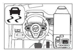
При работе системы ESC индикатор на комбинированном приборе мигает.
