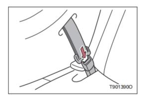
Нажмите кнопку разблокировки пряжки, чтобы полностью втянуть ремень безопасности.
