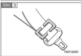
Если на детском удерживающем устройстве имеется фиксирующий зажим, то пропустите поясной и плечевой ремни безопасности через вогнутую часть фиксирующего зажима, затем установите фиксирующий зажим рядом с выпуклым язычком поясного и плечевого ремней безопасности. Снова пристегните ремень безопасности Если ремень безопасности ослаблен, то ослабьте пряжку и повторно установите фиксирующий зажим.
