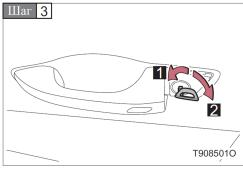
Потяните за открывающуюся наружу ручку левой передней двери, затем вставьте механический ключ в рабочее отверстие и подденьте кожух наружной ручки двери.
