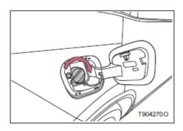
После заправки поверните крышку топливного бака, пока не раздастся звук щелчка.
