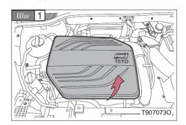
Снимите кожух украшения двигателя.
