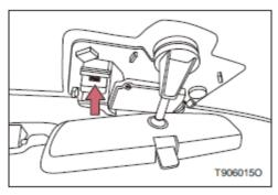
Этот интерфейс является интерфейсом автомобильного регистратора и может также использоваться для зарядки. (Чтобы увидеть интерфейс USB, необходимо снять крышку внутреннего зеркала).
