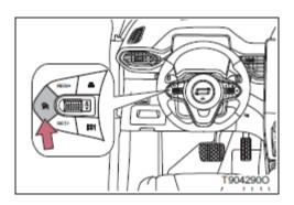
Нажмите на выключатель адаптивного круизконтроля, чтобы включить/выключить функцию круиза.
