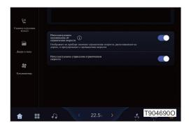
С помощью модуля "Помощь водителю" в разделе "Настройки автомобиля" большого экрана центрального управления можно включить или выключить функции интеллектуального напоминания об ограничении скорости и интеллектуального управления ограничением скорости.
