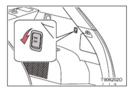
Крючки для крепления багажа расположены с правой стороны внутри багажного отсека. Используется для подвешивания некоторых легких предметов, что позволяет экономить место в багажном отделении.
