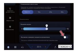
Модуль "Свет" в "Настройках автомобиля" центральной панели управления может быть настроен на автоматическое включение/выключение освещения салона.
