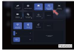
Способ V: Нажмите выключатель системы запуска и остановки на холостом ходу, и двигатель запустится автоматически.
