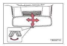
При необходимости функция предотвращения ослепления может быть включена или выключена с помощью рычага регулировки.
