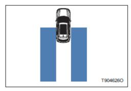
Функция помощи при смене полосы движения включается на скорости более или равной 30 км/ч, обнаруживая и идентифицируя автомобили, находящиеся на полосах движения с левой и правой сторон автомобиля, зона показана на рисунке.
