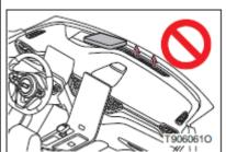
Не кладите на приборную панель ничего, что могло бы закрыть вентиляционные отверстия. В противном случае воздушный поток может быть заблокирован, что препятствует отпотеванию переднего ветрового стекла.
