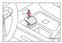
При остановленном автомобиле нажмите кнопку включения передачи Р. Автомобиль должен находиться на этой передаче при его выключении или запуске. Выполняйте вышесказанные шаги только после запуска двигателя.
