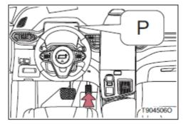
Способ III: Если передача находится в положении P, нажмите на педаль акселератора, и двигатель запустится автоматически.
