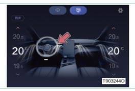
Коснитесь значка рулевого колеса в интерфейсе кондиционера, чтобы включать функцию подогрева рулевого колеса и при этом загорится индикатор, расположенный ниже; коснитесь еще раз, чтобы выключать функцию подогрева рулевого колеса и при этом данный индикатор погаснет.
