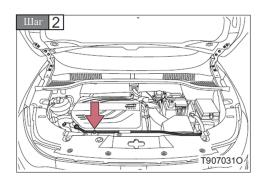
(Модели с механическими опорными стержнями) Перед закрытием капота, проверьте, зафиксирована ли распорная планка в зажиме.
