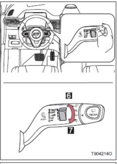
При выборе режима индукционного удаления воды можно регулировать чувствительность индукции.
