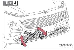
Извлеките сцепное устройство из ящика для инструментов.
