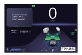
Если скорость автомобиля превышает 30 км/ч (километров в час), нажмите выключатель RES/+ для возобновления последнего состояния круиза, при этом заданная скорость круиза автомобиля автоматически устанавливается на последнюю скорость круиза.
