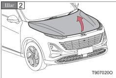
Потянитесь под капот и поднимите его вверх.
