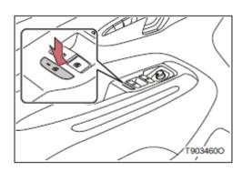
Нажмите выключатель блокировки стеклоподъемников, на выключателе загорится индикатор, и выключатель стеклоподъемников со стороны пассажиров на сиденьях заднего ряда будет выходить из строя.
