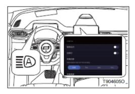
Интеллектуальная система управления фарой дальнего света может быть включена/выключена через модуль "Свет" в разделе "Настройки автомобиля" на экране центрального управления.
