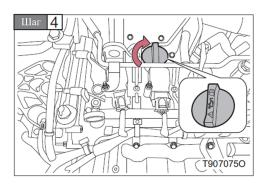
Поверните крышку маслозаливного отверстия по часовой стрелке и плотно затяните ее.
