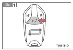
Нажмите и удерживайте выключатель открытия багажника на ключе более 2,5 секунд, чтобы разблокировать багажник и открыть его.
