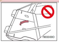
Перед опусканием спинок сидений заднего ряда обязательно отпустите пряжки ремней безопасности сидений заднего ряда и втяните ремни безопасности с обеих сторон по бокам сиденья, иначе можно повредить ремни безопасности, пряжки и спинки сидений.
