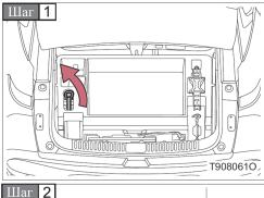
Извлеките сцепное устройство из ящика для инструментов.
