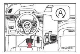
Способ I: Во время движения автомобиля полностью нажимайте на педаль тормоза до тех пор, пока скорость не станет нулевой, двигатель остановится автоматически, а педаль тормоза можно отпустить после переключения в положение Р.
