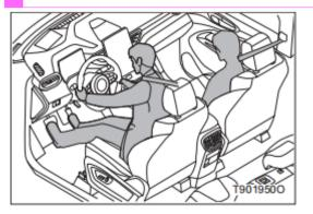
Когда автомобиль подвергается серьезному лобовому столкновению, передние и задние ремни безопасности быстро затягивают тело пассажира, а затем уменьшают усилие на плечевом ремне с помощью механизма ограничения усилия, чтобы уменьшить ущерб пассажиру.
