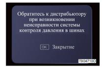
Система работает в режиме самоконтроля, и обнаружении неисправности комбинированном приборе начинает мигать неисправности сигнализатор системы контроля давления в шинах, одновременно отображаются звуковое текстовое оповещение "Обратитесь к дистрибьютору при возникновении неисправности системы контроля давления в шинах".
