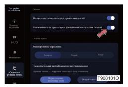
Если задние сиденья заняты нечасто, напоминание о ремнях безопасности задних пассажиров можно отключить с помощью модуля "Сиденья & рулевое колесо" в разделе "Настройки автомобиля" на центральной консоли.
