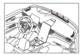
Нажмите кнопку режима размораживания/запотевания, при этом логотип будет подсвечен, чтобы включить режим размораживания/запотевания передней панели. Повторное нажатие переключателя отменяет логотип на дисплее высокой яркости и выключает режим оттаивания/запотевания передней панели.
