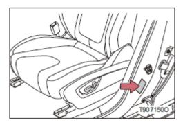
Табличка с указанием давления в шинах находится под стопорным штифтом стойки В со стороны водителя.
