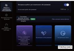
На странице технического обслуживания менеджера автомобиля отображается текст напоминания о необходимости замены фильтроэлемента: Состояние фильтроэлемента кондиционера: Пожалуйста, замените его, и отображается кнопка "Сброс замены фильтроэлемента".
