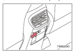
Этот интерфейс USB обеспечивает функцию зарядки внешних устройств.
