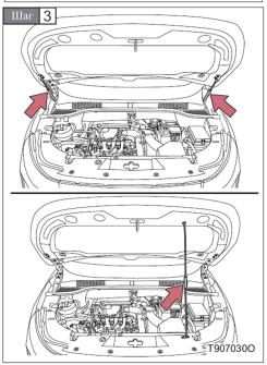
Поднимите капот, и он автоматически останется открытым (автомобили с газовыми стойками).
