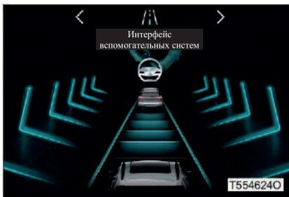
В активированном состоянии системы и коррекции левой/правой полосы движения или центрирования полосы движения по центру, если осуществляется управление рулевым управлением, на вспомогательном показываемом изображении появляется значок рулевого колеса.
