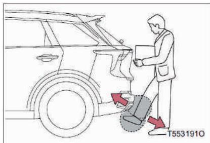
Встаньте с умным ключом посередине заднего бампера, быстро махните ногой вперед под бампер так, чтобы голень находился в верхней области считывания, а ступня - в нижней, затем быстро уберите ногу, чтобы сработал датчик открывания багажника.
