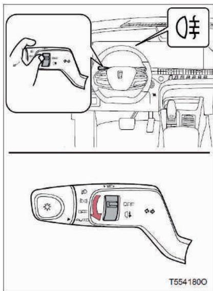
Выключатель противотуманных фар - автоматический возвратный. После каждого управления переключатель автоматически возвращается в положение OFF.
