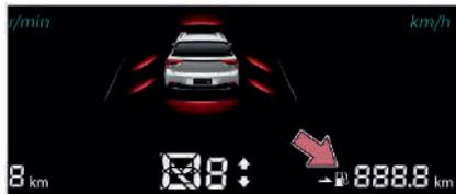
Отображает приблизительное расстояние, которое может проехать автомобиль при текущем уровне топлива.
