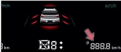
Отображение средней скорости автомобиля с момента сброса данной функции.
