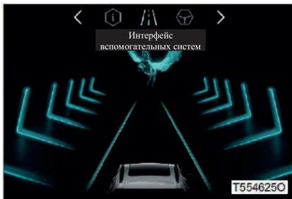
При нормальной работе системы индикаторная лампа состояния системы помощи в удержании полосы движения на комбинации приборов загорается зеленым цветом, а полоса движения на вспомогательном показываемом изображении отображается синим цветом.
