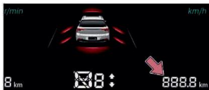
Отображение пробега автомобиля, пройденного с момента последнего сброса информации о движении автомобиля (сброса настроек).
