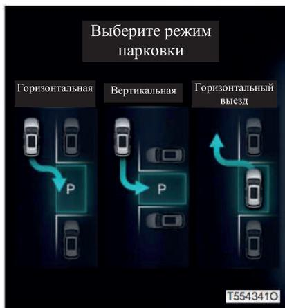
При запуске двигателя и скорости 25 км/ч (км/ч) или ниже нажмите автоматический парковочный выключатель, на дисплее аудиосистемы появляется интерфейс выбора режима парковки, после выбора горизонтального или вертикального режима парковки система переходит в режим «Поиск парковочного места».
