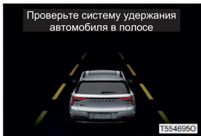
Если система удержания в полосе неисправна, индикатор состояния системы удержания в полосе на приборной панели загорится желтым цветом и появится сообщение «Проверьте систему удержания в полосе»; обратитесь в Центр продаж и обслуживания FAW Car для проведения проверки.
