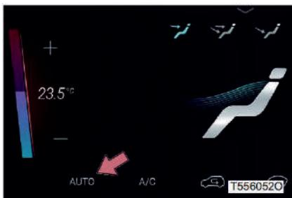
Нажмите кнопку AUTO в разделе настройки автоматического кондиционирования воздуха на экране аудиосистемы, чтобы войти в режим работы AUTO. Благодаря автоматическому управлению интенсивности подачи воздуха, режимом циркуляции, режимом подачи воздуха, температурой воздуха на выходе и рабочим состоянием компрессора, в салоне автомобиля поддерживается стабильная общая температура.
