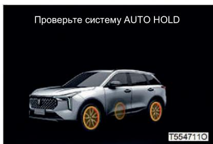
Если система AUTO HOLD неисправна, то на приборной панели появится сообщение «Проверьте систему AUTO HOLD», обратитесь в Центр продаж и обслуживания FAW Car для проведения проверки.
