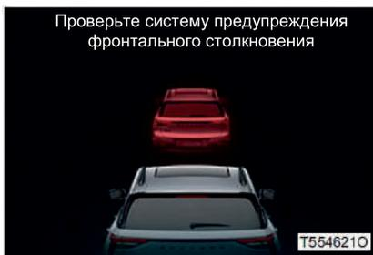
Если система предупреждения фронтального столкновения неисправна, индикатор предупреждения фронтального столкновения/автоматической системы экстренного торможения на приборной панели загорается желтым цветом и появляется подсказка «Проверьте систему предупреждения фронтального столкновения»; обратитесь в Центр продаж и обслуживания FAW Car для проведения проверки.
