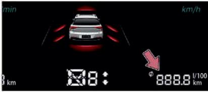
Отображение среднего расхода топлива автомобиля с момента сброса данной функции.
