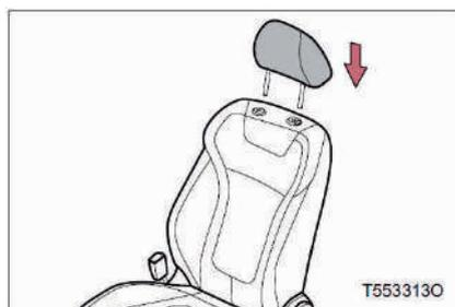
Вставьте подголовник в монтажные отверстия и опускайте его до положения блокировки.
