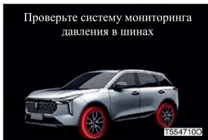
Система осуществляет самомониторинг, и в случае обнаружения неисправности на комбинации приборов будет мигать сигнализирующая лампа неисправности системы контроля давления в шинах, наряду со звуковым подсказкой и текстовым подсказкой «Проверьте, пожалуйста, систему контроля давления в шинах».
