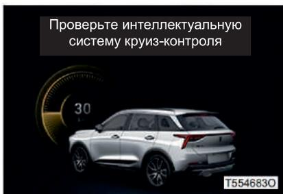
При неисправности системы индикатор ассистента движения в пробках/интегрированной системы круиз-контроля на приборной панели загорится желтым цветом и появится сообщение «Проверьте интеллектуальную систему круиз-контроля»; обратитесь в Центр продаж и обслуживания FAW Car для проведения проверки.
