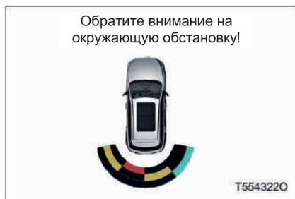
При обнаружении препятствия на дисплее аудиосистемы загорается соответствующий колор-блок, а динамик звучат с определенной частотой, предупреждая водителя.
