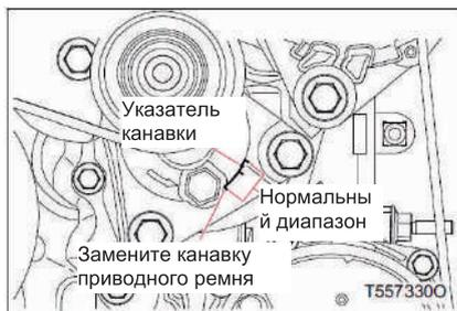
Проверьте крен и натяжение приводного ремня, а также визуально проверьте, не выходит ли линия указателя автоматического натяжителя приводного ремня за предельное положение. Если предельное положение превышено, замените приводной ремень.
