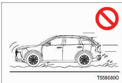
Езда по залитым водой дорогам может привести к остановке двигателя, короткому замыканию электрических компонентов и попаданию воды внутрь. Не пытайтесь запустить двигатель после того, как он заглох, это может привести к серьезным повреждениям двигателя.
