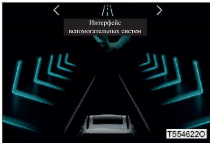
Если система находится в режиме ожидания или активируется, если линия полосы движения не обнаружена, индикаторная лампа состояния системы помощи в удержании полосы движения на комбинации приборов загорается серым цветом, а правая и левая полосы движения на вспомогательном показываемом изображении отображаются серым цветом.
