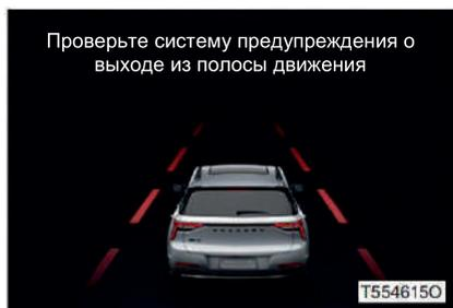
Если система находится в режиме ожидания или активирована, если линия полосы движения не обнаружена, то индикаторная лампа состояния системы предупреждения о сходе с полосы движения на комбинации приборов загорается серым цветом, а левая и правая полосы движения на вспомогательном показываемом изображении отображаются серым цветом.
